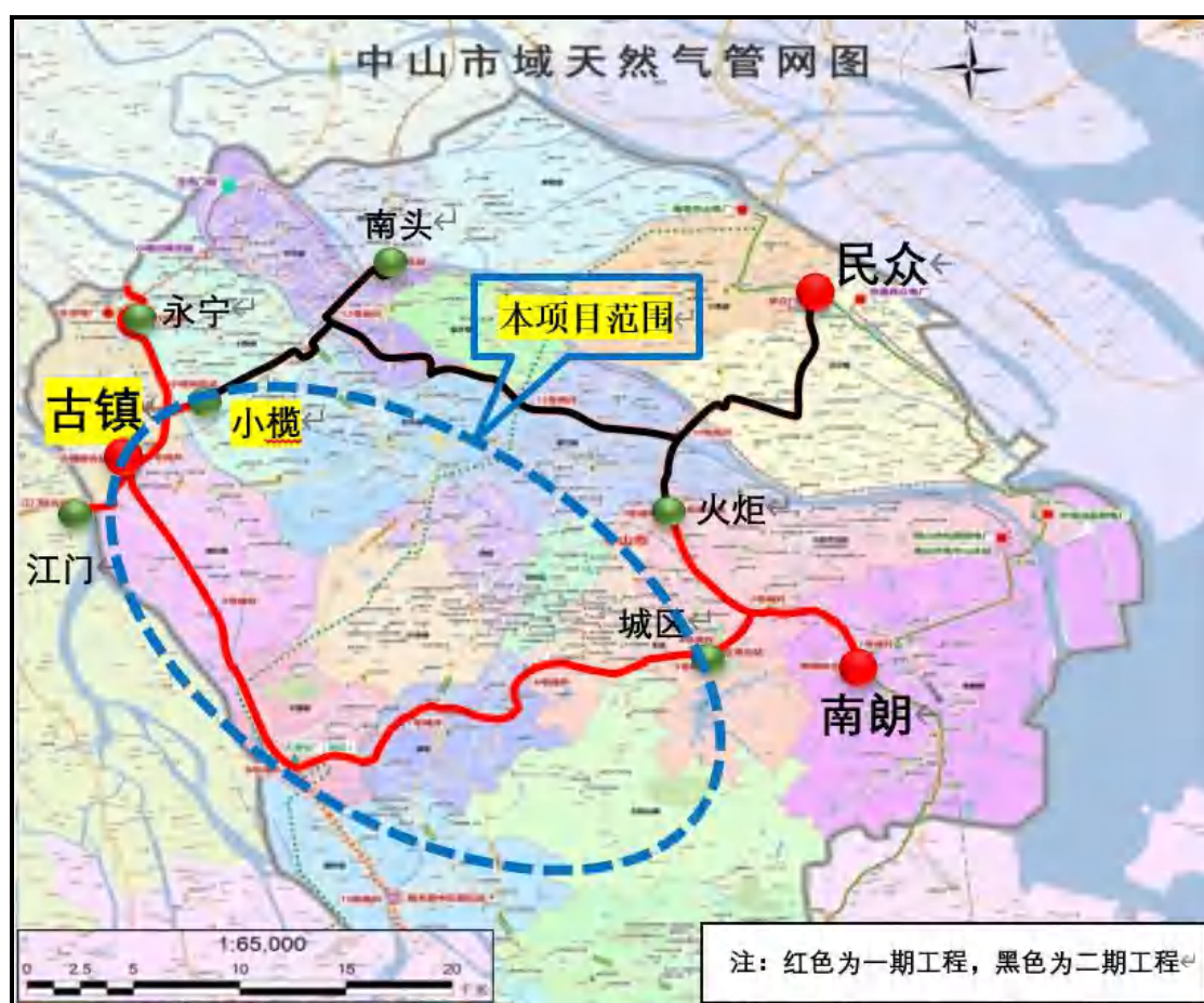
图 2.2-1 中山市域天然气利用项目一、二期工程的环状示意图
